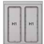
Cajón 500 Ancho 400 a 440 Fondo 430 a 490 Hueco tipo H1+ H1
